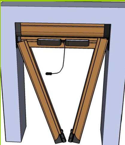
**3** INSERIRE IL CASSONETTO NEL VANO DELLA FINESTRA E TENENDOLO CON UNA MANO INSERIRE LE GUIDE LATERALI COMPLETE DEL PIEDINO
