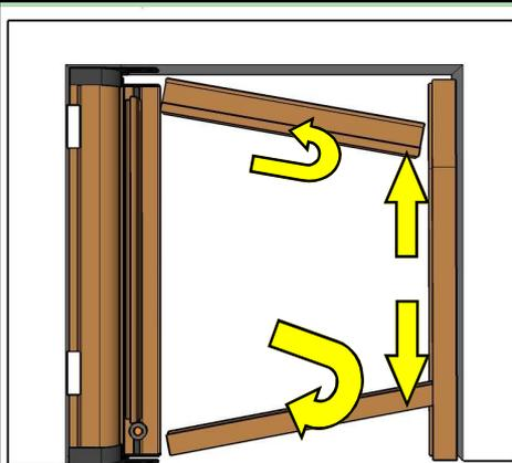
Inserire la guida superiore ed inferiore fissare la guida superiore per mezzo della piastrina
