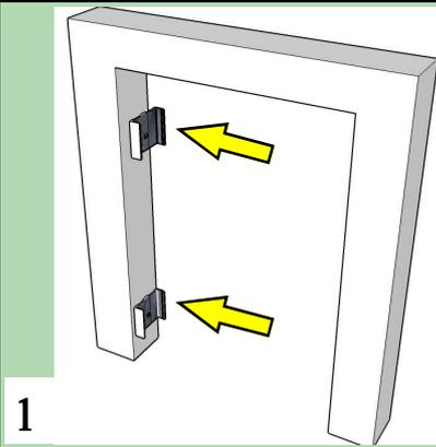
Avvitare le clips di supporto cassonetto al lato del muro dove si vuole installare la zanzariera.
