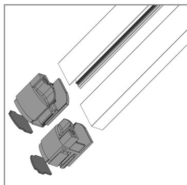
**4** Attaccare l'adesivo, che trovate all'interno della confezione, ai piedini, servirà a mantenere ferme le guide nelle seguenti operazioni di montaggio. Inserire i piedini nelle guide rispettando il verso d'ingresso, ottenendo quanto riportato nella seconda figura qui sopra.
