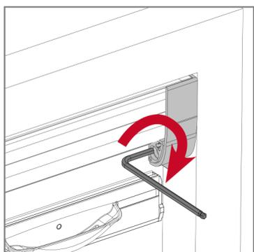
**6** Regolare le testate ad espansione tramite le apposite viti. **Far aderire le testate al vano abbastanza da correggere eventuali problemi di fuori squadra.** Inserire il tappino di chiusura nello spazio preposto sulle testate.
