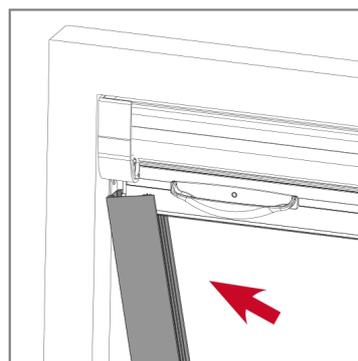
**5** Inserire le guide laterali sx e dx nell'invito guida delle testate. Far aderire l'adesivo al vano.
